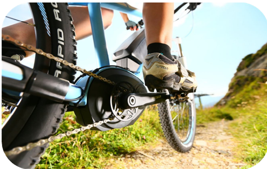
Fot.7. Rower z centralnym wspomaganie elektrycznym, źródło: materiały prasowe firmy Haibike
