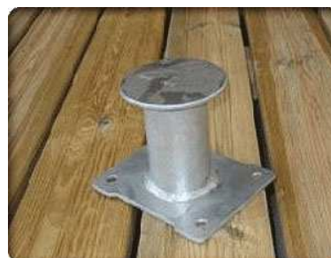
Fot.20.21. Knaga, pachołek – mocowanie do górnej części pokładu
