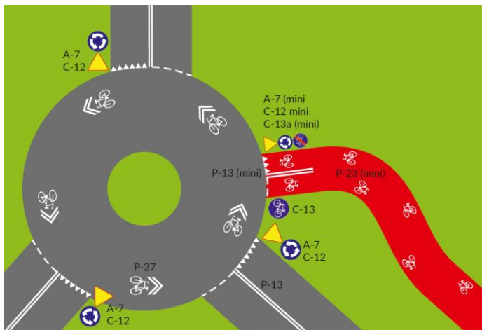
Rysunek 46. Początek/koniec drogi rowerowej na rondzie. Źródło: opracowanie własne
