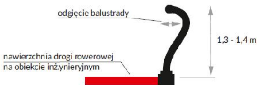
Rys. 26. Odgięcie balustrady na obiekcie inżynierskim
