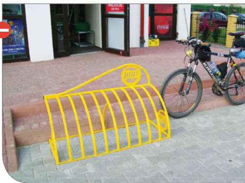
Stojaki nie pozwalające na właściwe zabezpieczenie i pozostawienie roweru. Fot. M. Szydąg / T. Milewski
