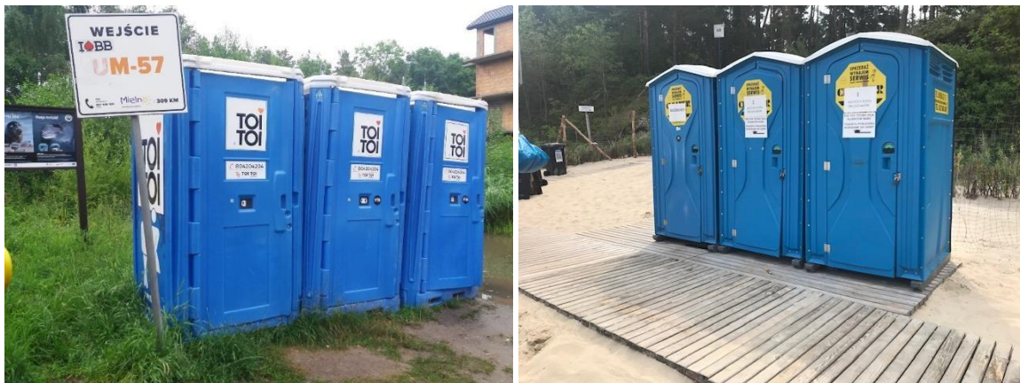
Fot. 33. Nieprawidłowe ustawienie toalet: brak wygodnego, utwardzonego dojścia (po lewej)
