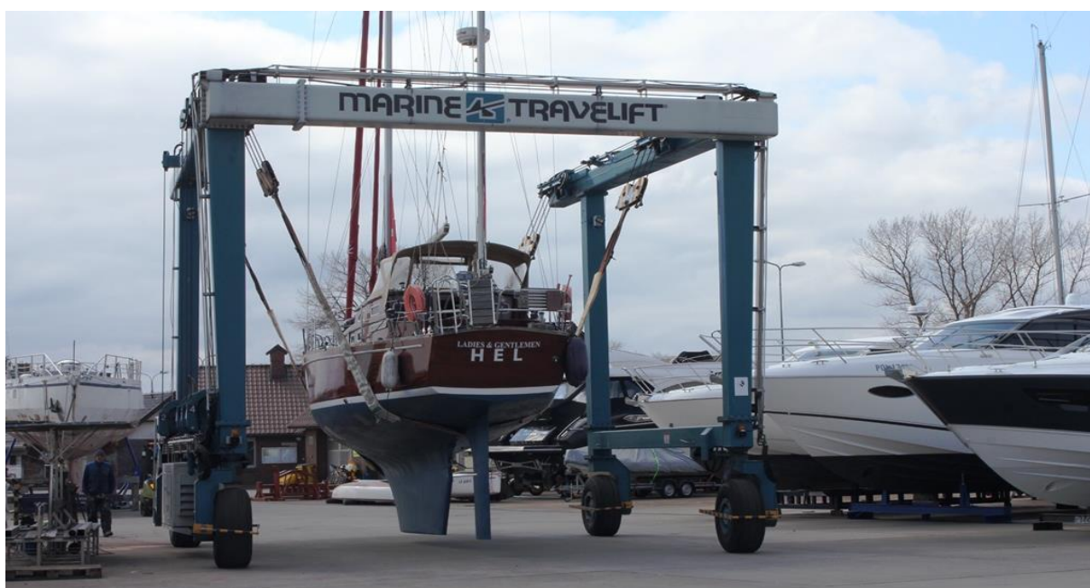
Fot.27. Specjalistyczna bramownica do wyciąganie i wodowanie jachtów; źródło: archiwum własne
