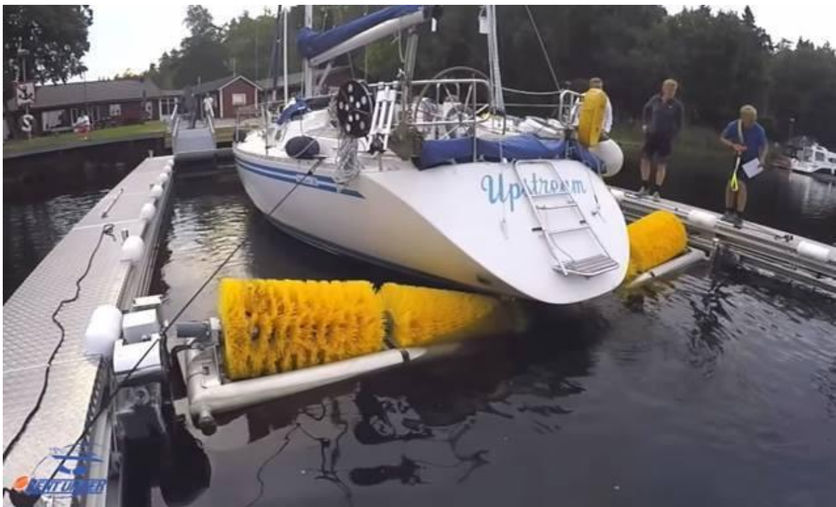
Fot.59. Automatyka myjnia podwodnej części kadłuba;
