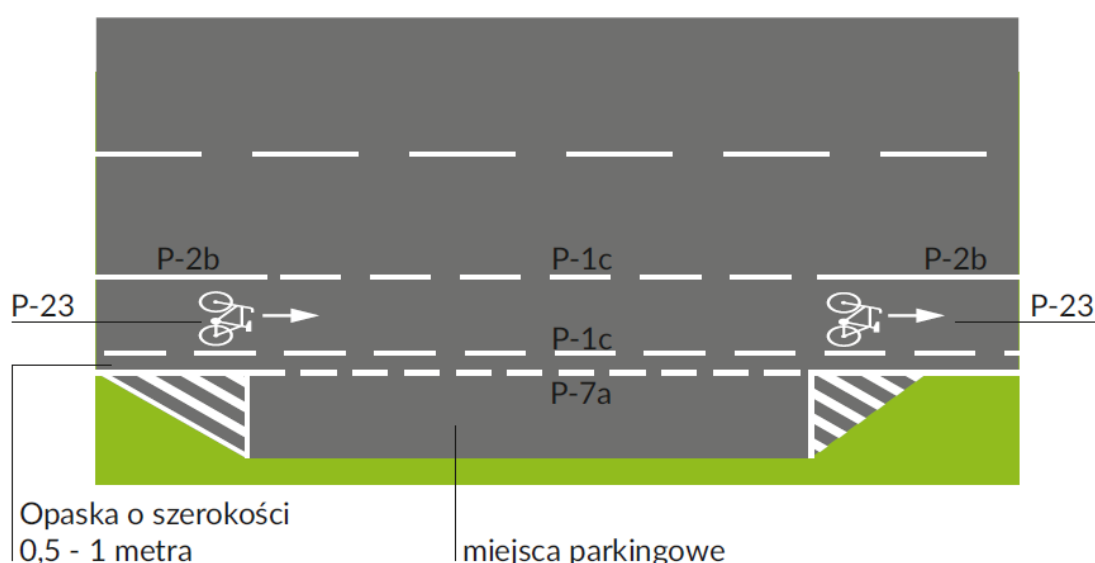
Rysunek 29. Przykład prowadzenia pasa rowerowego wzdłuż wyznaczonego pasa do parkowania pojazdów / miejsc do parkowania. Źródło: opracowanie własne.
