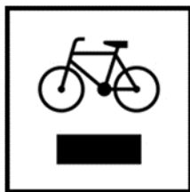
R-1: przebieg lokalnego szlaku rowerowego
