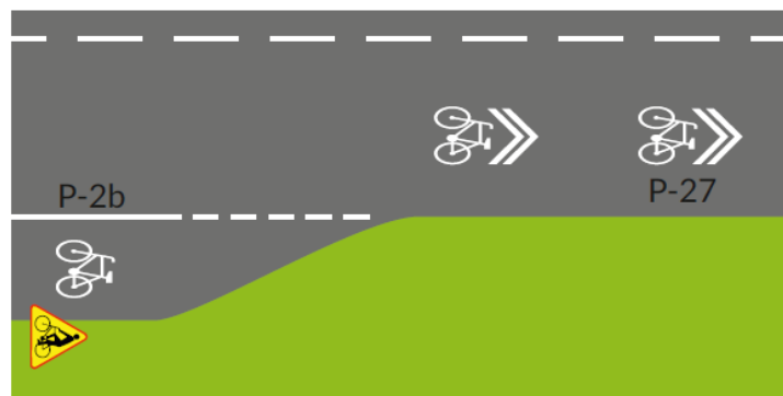
Rysunek 26. Przykład stosowania znaków P-27 dla zachowania ciągłości pasa ruchu dla rowerów. Źródło: opracowanie własne.
