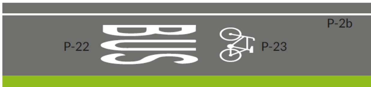
Rysunek 28. Pas ruchu dla rowerów poprowadzony na buspasie. Źródło: opracowanie własne.
